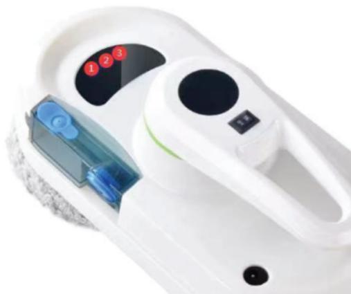
**La première LED à gauche (1)**, indique l'état de la batterie. Lorsque le niveau de la batterie est faible ou que la batterie est en charge, le voyant s'allume en rouge. Lorsque le robot est chargé, l'indicateur devient bleu.
