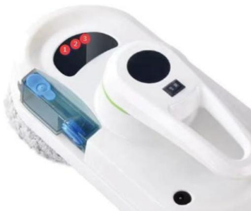
**Il primo LED a sinistra (1)** indica lo stato della batteria. Quando il livello della batteria è basso o la batteria è in carica, l'indicatore illumina in rosso. Quando il robot è caricato, l'indicatore diventa blu.
