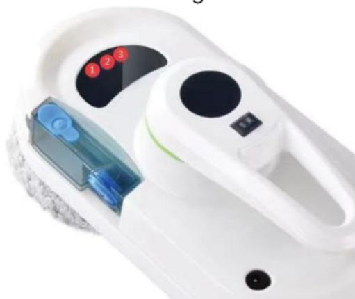
**Die erste LED** auf der linken Seite (1) zeigt den Batteriestatus an. Wenn der Batteriestand niedrig ist oder die Batterie aufgeladen wird, leuchtet die Anzeige rot. Wenn der Roboter aufgeladen ist, leuchtet die Anzeige blau.
