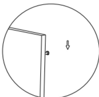
7.3 Installer la sonde de mesure sur le mur à l'aide du ruban adhésif avec double adhésif et ne laissez aucun espace entre le sol et la sonde de mesure.
