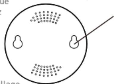
2) Installez les deux vis de l'emballage et laissez une marge de 5 - 8 mm contre le mur. Ensuite, l'appareil peut être fixé.
